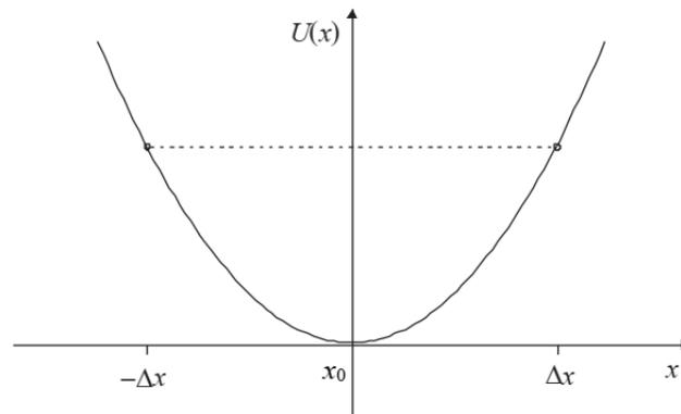
**Abbildung 3:** Bindungspotential der an der Feder befestigten Masse mit Äquipotentiallinie der Maximalauslenkung um  $\pm\Delta x$
