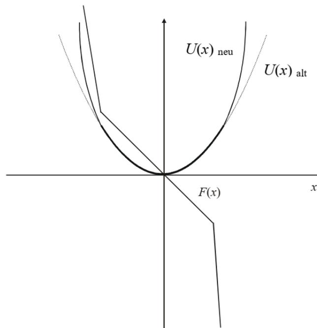
**Abbildung 4:** Bindungspotential der steifer werdenden Feder mit zugehöriger Kraftkurve (schematisch)
