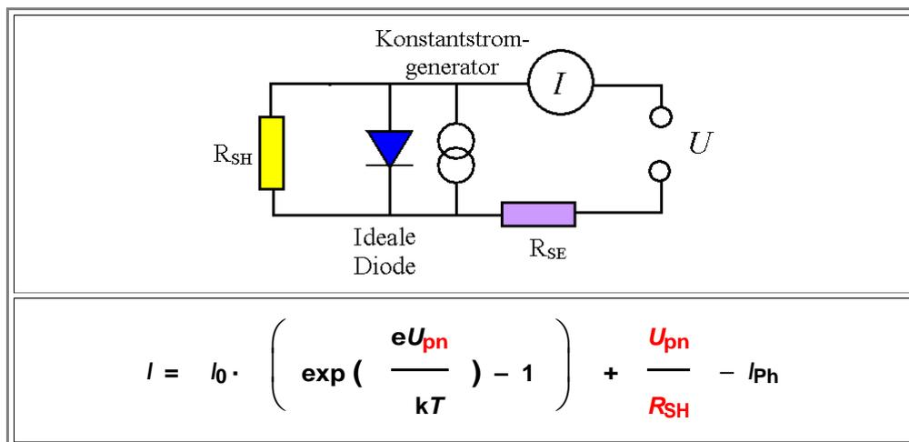
Wie kommt man von der Diodengleichung auf diese Kennlinie? Dem **ET&IT**-Ingenieur ist das klar, den anderen wird's erklärt:
