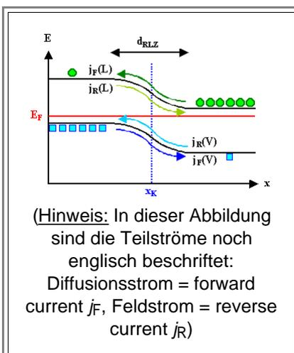
3. *Verbinde Leitungs- und Valenzband durch eine "gefühlsmäßig" gezeichnete Bandverbiegung.*
