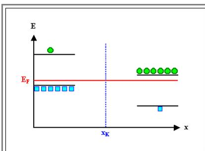
2. *Zeichne "weit" links vom Kontakt das schematische Banddiagramm von Material 1 und weit rechts das von Material 2 – immer relativ zu der zuvor festgelegten Fermienergie.*
