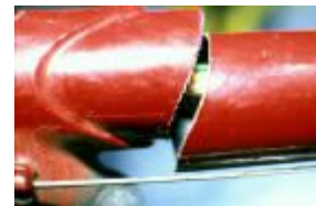
Gebrochener Fahrradrahmen - lebensgefährlich!
