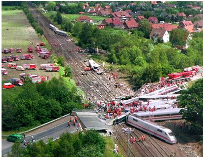
Die Folge eines gebrochenen Radreifens
