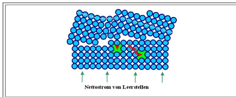
Am nachfolgenden Bild ist der *Umkehrprozeß*, die Netto*emission* von Leerstellen an einer Modellkorngrenze dargestellt. Das heißt, daß mehr Leerstellen in der Korngrenze generiert als absorbiert werden.
