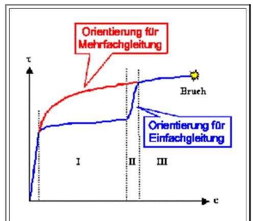
Die kritische Scherspannung  $\tau_{krit}$ , ab der plastische Verformung einsetzt, kann durch geeignete Maßnahmen in weiten Grenzen manipuliert werden.
