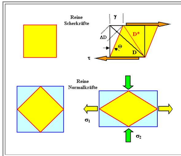
Oben die Verformung mit reinen Scherkräften, unten exakt die gleiche Verformung mit reinen Normalkräften - nach Drehung um  $45^\circ$  und "Einbettung".
