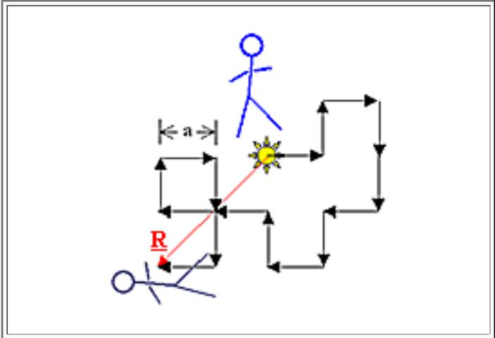
Mit  $N = r \cdot t$ , der Sprungrate  $r$  aus den alten Beziehungen sowie der Verknüpfung von  $r$  mit dem Diffusionskoeffizienten  $D$ , erhält man für die *Diffusionslänge*  $L$ , dem mittleren Abstand vom Startpunkt als Funktion der Zeit, eine *fundamentale Beziehung*, die wir noch oft brauchen werden:
