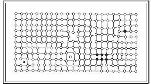
**Intrinsische** nulldimensionale Defekte sind **Leerstelle** und (Eigen)**zwischengitteratom**; sie müssen für thermisches Gleichgewicht mit einer Konzentration  $n_i$  vorhanden sein
