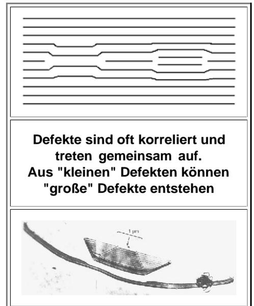
Entscheidend für die Bildung größerer Defekte ist die **Keimbildung**.
