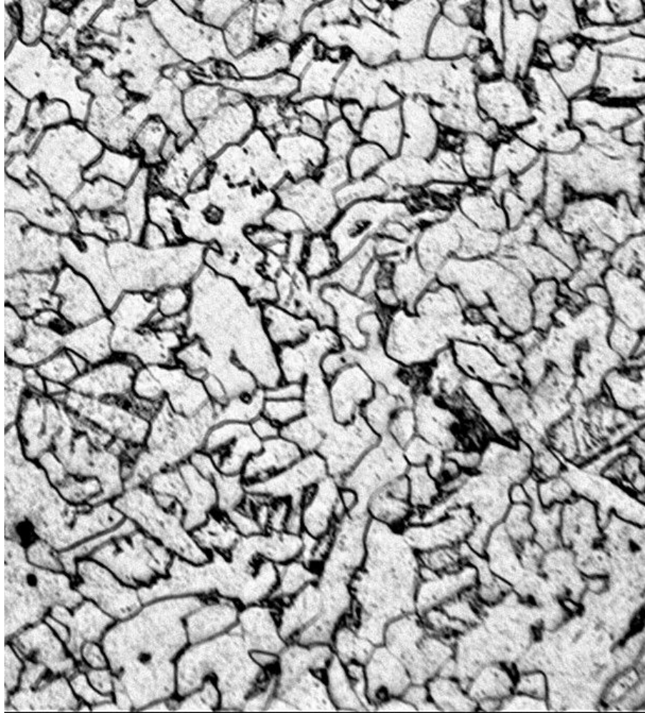
Fig. 4-3: Schwert IR3746. Ferritgefüge mit wenig Perlit im Bereich 2.
