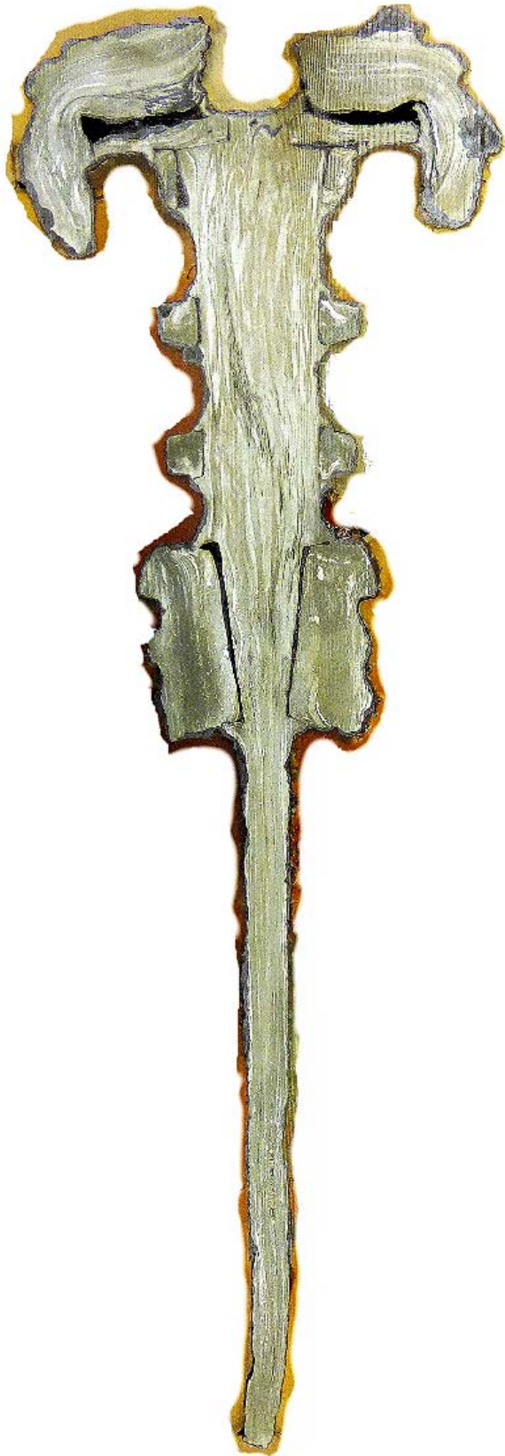
Fig. 2-2: Schwerthälfte IR3744 Nital Ätzung Bochum
