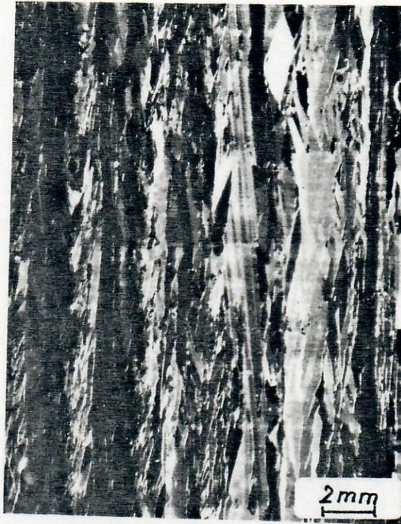
Abb. 12 Angeätzte Körner auf vertikal gezogenem S-Web-Band; → Ziehrichtung.
