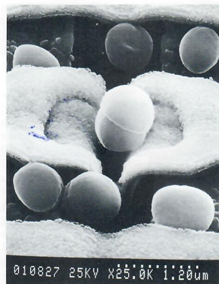
Bild 11. Mikrokokken auf Leiterbahnen eines 4-Mbit-DRAM (H. Haudek, Siemens).
