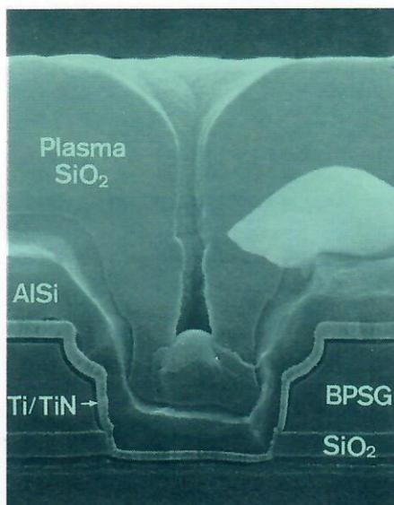
Bild 10. Der Kontakt der Wortleitungen zum Halbleitermaterial wird in den sogenannten **Kontaktlöchern** realisiert. Damit nach dem Sputtern genügend Aluminium die Seitenwände und den Boden des Kontaktlochs bedecken, müssen die Kontaktlöcher abgeschragt werden. Der helle Aluminiumfleck ist ein durch die Präparation entstandener Artefakt.
