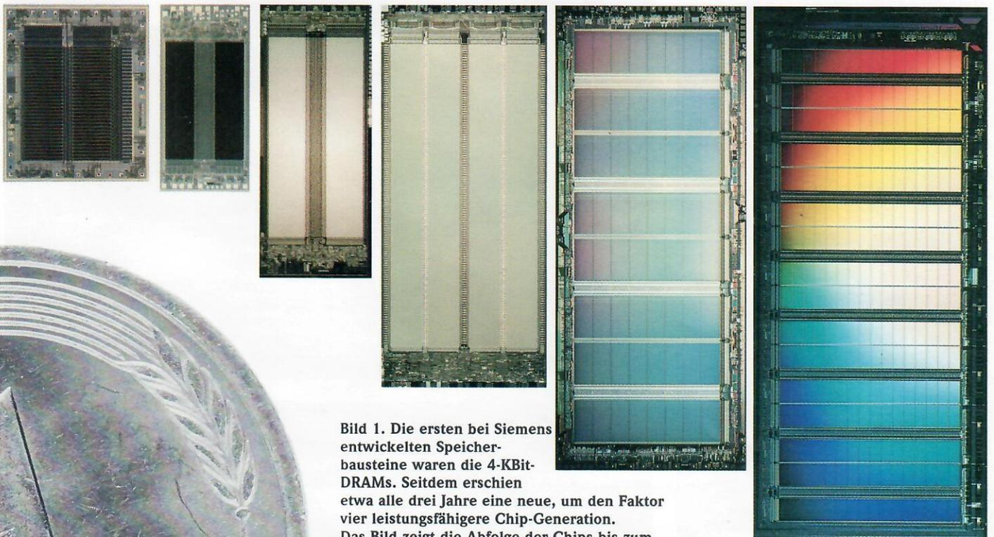
**Bild 1.** Die ersten bei Siemens entwickelten Speicherbausteine waren die 4-KBit-DRAMs. Seitdem erschien etwa alle drei Jahre eine neue, um den Faktor vier leistungsfähigere Chip-Generation. Das Bild zeigt die Abfolge der Chips bis zum Prototypen des 16-MBit-Speichers von 1990. Deutlich zu erkennen ist die Vergrößerung der Chip-Fläche. Zum Vergleich ist ein Pfennig-Stück eingebildet.
