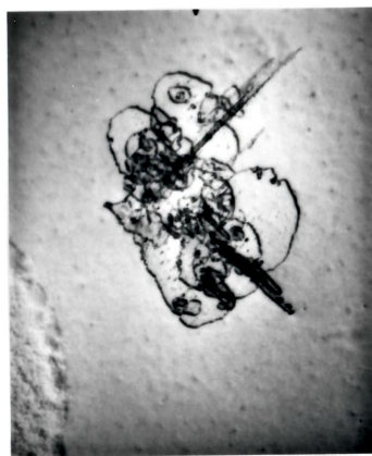
Abb. 68 Komplizierter Kristalldefekt, der durch Ausscheidung von Kupfer entstanden ist. Die eigentlichen Cu-Silicid-Ausscheidungen sind die winzigen punktförmigen oder kaffeebohnenartigen Kontraste, die Versetzungsschleifen vom Zwischengitteratomtyp generiert haben (TEM).
