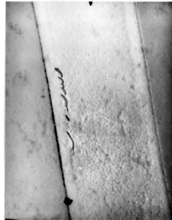
Abb. 43 TEM-Aufnahmen von mikrorißartigen Defekten in Emittern von Höchstfrequenztransistoren: Der über 10 μm lange Mikroriß in a) verursachte ein massives pipe. In b) ist eine Vorstufe eines Mikrorisses abgebildet, die noch kein pipe ergeben hat.
