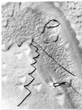
Abb. 37 Typische Formen von helixartigen Versetzungen in Emitterbereichen von Transistoren in SBC-Technologie (TEM) a) Helixartige Versetzungen mit großem Windungsabstand und -durchmesser. b) Unregelmäßige Helixversetzung mit einzelnen dipolartigen Segmenten bis zu 1 μm Länge, die steil in die Tiefe verlaufen. c) In eine Reihe von coaxialen Versetzungsringen aufgelöste Helixversetzung.
