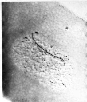
Abb. 27 "Oxidbegrenzter" Emitter mit pipe, das durch einen Stapelfehler am Rand der Oxidisolations verursacht wurde. (TEM)
