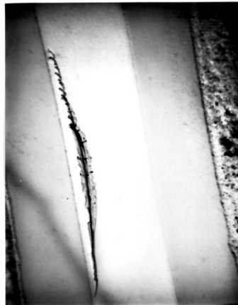
Abb. 43 TEM-Aufnahmen von mikrorißartigen Defekten in Emittern von Höchstfrequenztransistoren: Der über 10 μm lange Mikroriß in a) verursachte ein massives pipe. In b) ist eine Vorstufe eines Mikrorisses abgebildet, die noch kein pipe ergeben hat.
