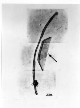
Abb. 13 TEM-Aufnahme eines Transistorbereichs mit kleinen Stapelfehlern, gr. Stapelfehlern, gr. Mehrfach-Stapelfehlern (M) und Versetzungen (V)
