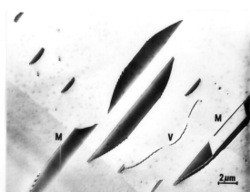
Abb. 13 TEM-Aufnahme eines Transistorbereichs mit kleinen Stapelfehlern, gr. Stapelfehlern, gr. Mehrfach-Stapelfehlern (M) und Versetzungen (V)
